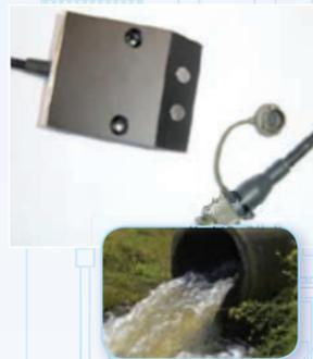
Le capteur de surverse est autoalimenté et indique la présence d'eau lors de son immersion. Le système mesure la durée de déversement. Le capteur a un profil spécialement conçu pour éviter l'accumulation de sédiments.
