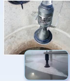
Ce capteur utilise des micro-ondes pulsées permettant la mesure de niveau de haute précision sur une large bande; capteur non affecté par l'humidité, les mousses de surface, etc..., qui peuvent créer de faux échos.
