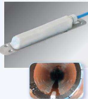
Le procédé Doppler utilise un signal continu, envoyé par ultrasons dans l'eau avec un angle connu afin de mesurer la vitesse d'écoulement. Les particules en mouvement génèrent un décalage de fréquence proportionnel à la vitesse.
