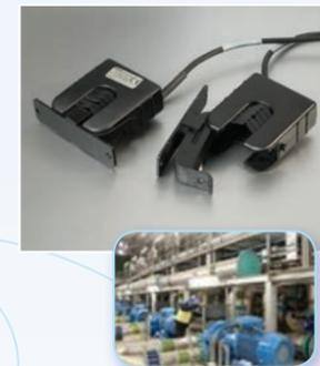
La pince ampérométrique détecte le démarrage d'une pompe et permet ainsi la surveillance et la fréquence de fonctionnement des pompes. Le volume d'eau pompée est alors calculé à partir du temps de fonctionnement de la pompe.
