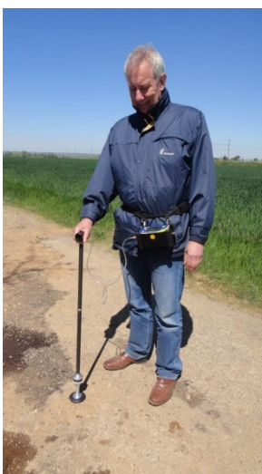
Détection du gaz traceur sur ce site d'essai
