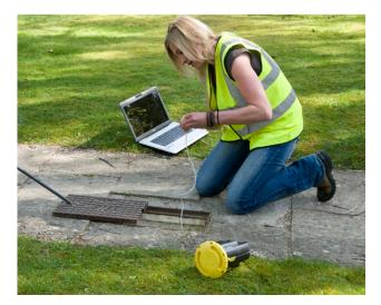
La entrada de caudal puede registrar dos caudales unidireccionales o un caudal bidireccional. Asimismo, las dos salidas de los medidores de combinación se pueden registrar en el canal de entrada de un registrador. El valor índice del medidor existente se puede introducir al comienzo del registro.
