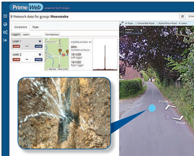
Street View permet la visualisation des positions de fuites.
