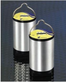
El uso nocturno ofrece las condiciones ideales para la detección de fugas. Esto se debe a que el ruido acústico de fondo producido por el tráfico, el consumo de agua y otras fuentes, es más bajo y, al mismo tiempo, la presión del sistema de agua puede ser mayor, lo cual facilita enormemente la propagación del ruido de fugas.
