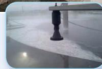
Ce capteur utilise des micro-ondes pulsées permettant la mesure de niveau de haute précision sur une large bande; capteur non affecté par l'humidité, les mousses de surface, etc..., qui peuvent créer de faux échos.
