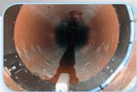
Le procédé Doppler utilise un signal continu, envoyé par ultrasons dans l'eau avec un angle connu afin de mesurer la vitesse d'écoulement. Les particules en mouvement génèrent un décalage de fréquence proportionnel à la vitesse.
