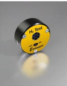
Ce dispositif simple et rapide permet de tester le bon fonctionnement du système PrimeTrace y compris les sondes. Avec cette source d'hydrogène, une fuite est facilement simulée. La cellule est interchangeable et permet 500 tests.
