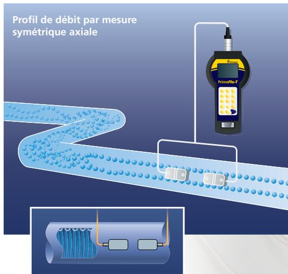
Profil de débit par mesure symétrique axiale
