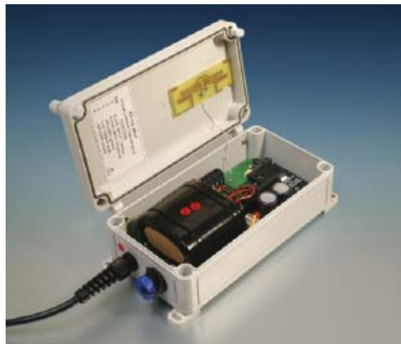
Modèle de surface conforme à la norme IP66
